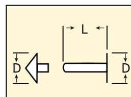
材質 鉄+真鍮 ※頭のキャップは真鍮。その他の部分は鉄製。
