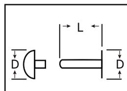
材質 鉄+真鍮 ※頭のカップは真鍮。その他の部分は鉄製。
